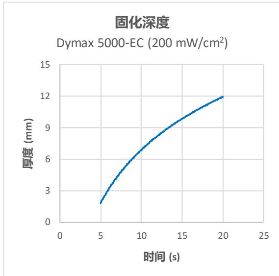
固化速度取决于许多变量，包括固化时间、不同的光强，并应测量相应的固化后性能的变化，如粘性、粘接力、硬度等等。完全固化定义为即使施加更多的能量，胶水固化后的性能也不会改善。通常，更高的光强或更长的固化时间（五倍以内）不会降解固化材料。
